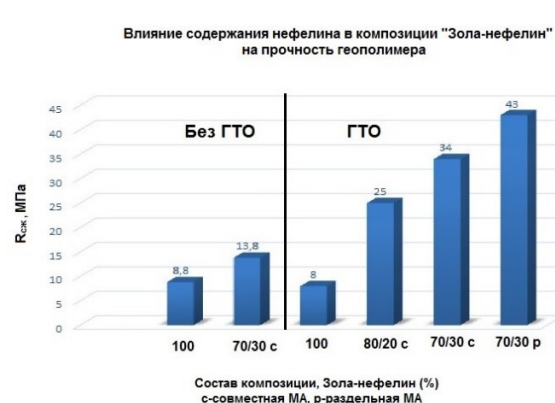
Рис. 5. Влияние состава композиции и условий твердения на R_{сж} геополимеров на основе смесей золы и НК в возрасте 180 сут. Время МА в мельнице: совместная МА — 180 с; раздельная МА — зола 180 с, НК 400 с, смешение 30 с
